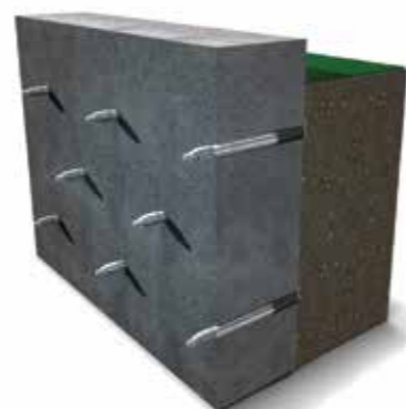
Reabilitação do contato da ombreira com solo
