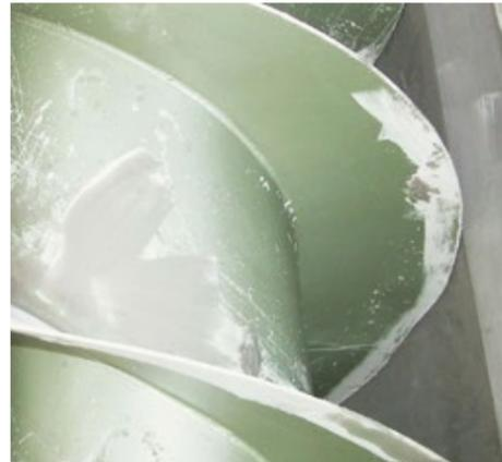
Calha do parafuso revestida e reparada, pronta para o trabalho de bombeamento.
