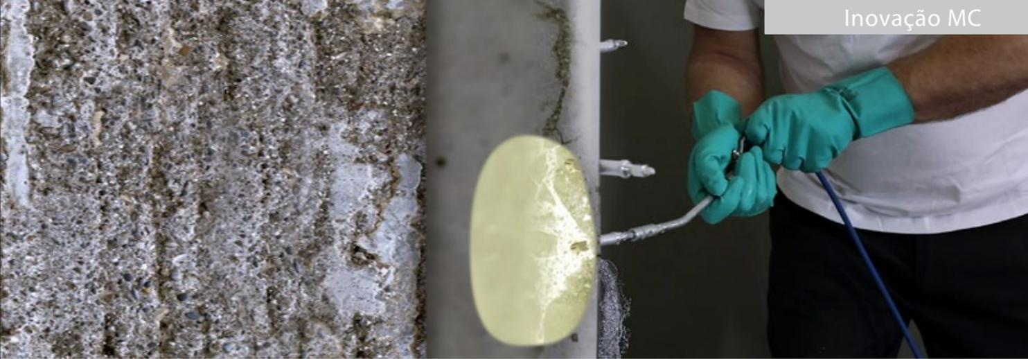
A ilustração acima mostra como a MC-Injekt 2133 sela em definitivo trincas, fissuras e cavidades interrompendo a infiltração.
