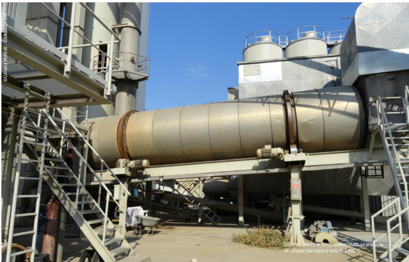
Esquema técnico de forno rotativo usado na produção de clínquer, que opera a mais de 1.400 °C.
